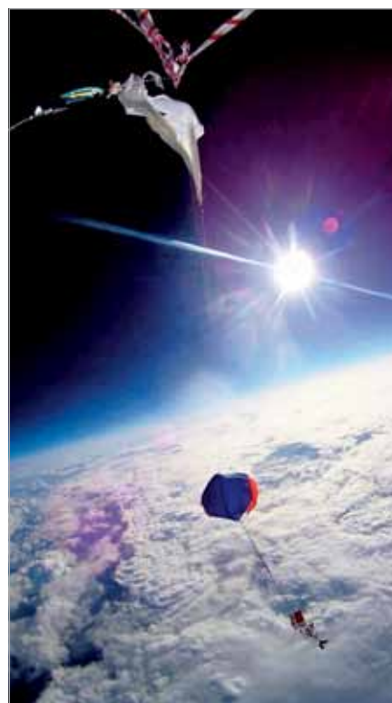
Zlot ze stratosfery – gondola główna opada na spadochronie, ponad nią widoczny flak balonu oraz fragmenty anteny. Kadr z filmu nagrywanego przez kamerę umieszczoną na mocowaniu anteny. Fot.: Sekcja Balonowa SKA
