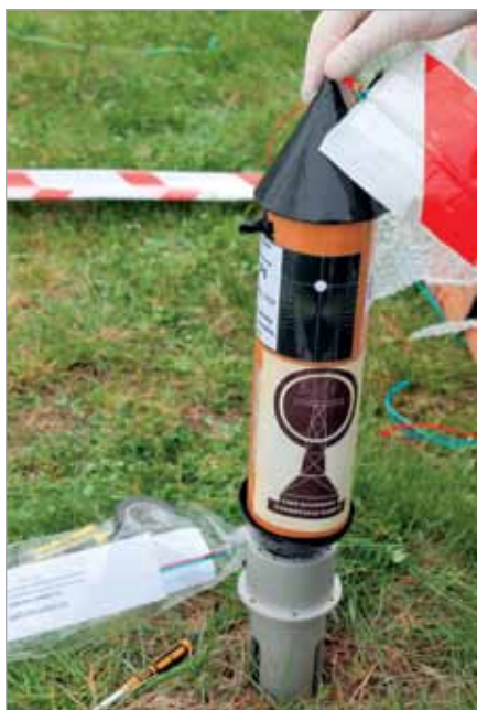
Gondolka antenowa eksperymentu CAPELLA P1. Sama antena, w biało-czerwonych barwach, widoczna u góry i w tle. Fot.: Tomasz A. Miś
